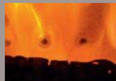
Tertiärluft wird durch Düsen im hinteren Brennraumbereich „eingeblassen“.
